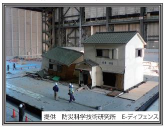
耐震改修を適切に行えば、 古い耐震基準の建物も地震に 強くなります。
